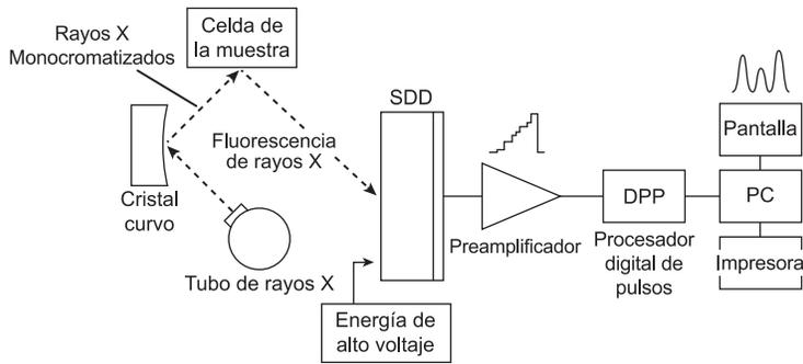
**Diagrama de bloques del principio de medición**
